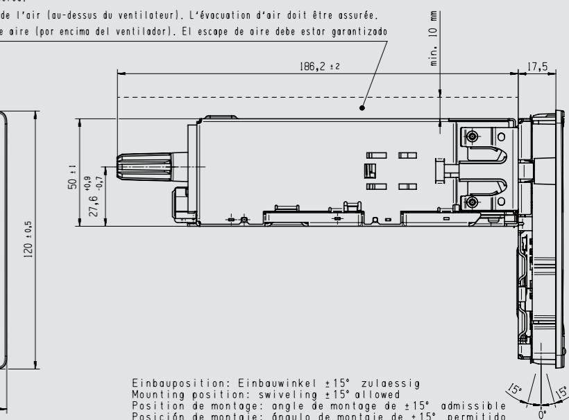
Einbauposition: Einbauwinkel ±15° zulässig
